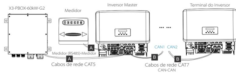
Se o utilizador for utilizado com o inversor X3-Hybrid/Fit G2, ligue como se segue:
