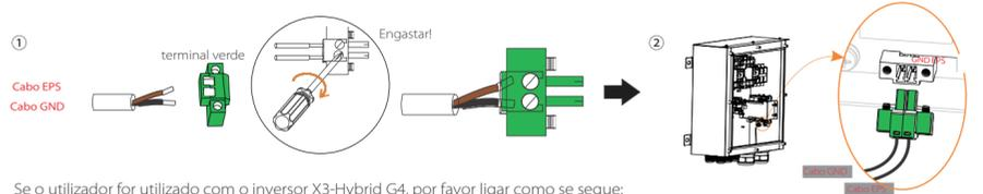
Se o utilizador for utilizado com o inversor X3-Hybrid G4, por favor ligue como se segue: Utilizar um cabo de rede comum e remover 4 mm de isolamento das extremidades dos cabos.
