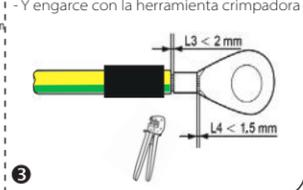
4 - Tire del tubo termorretráctil en la sección crimpada del terminal de ojo.
