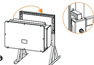
6 - Fijelo en el soporte con tornillos M8.
