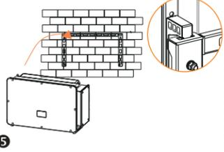
6 - Fijelo en el soporte con tornillos M8.
