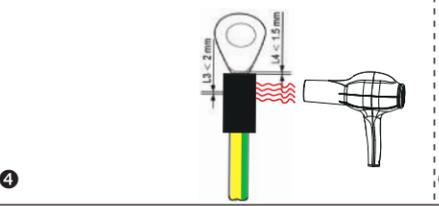
5 - Conecte el cable de conexión a tierra al punto de conexión a tierra del inversor.
