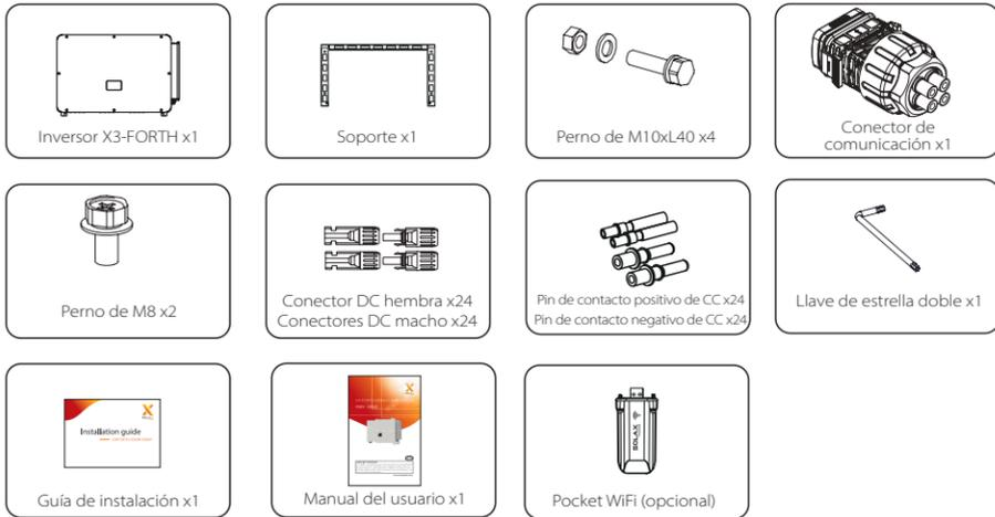
\*Nota: la llave de estrella doble de la caja de accesorios se utiliza para retirar los tornillos de la tapa frontal del inversor. Guárdelo en un lugar seguro
