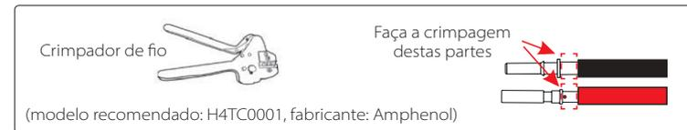
e) Separe o conector CC como duas partes: a tomada e a porca do cabo. Depois insira o fio com o contacto através da porca do cabo.
